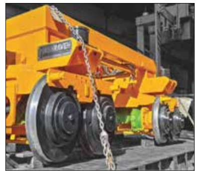
تعمیر و بازسازی بوم دیفرانسیل ناحیه نورد گرم
