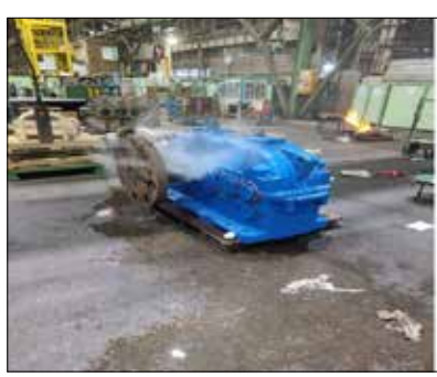
تعمیر طرح گیربکس میکسر (تغییر یاتاقان بندی و افزایش طول عمر کاری)
